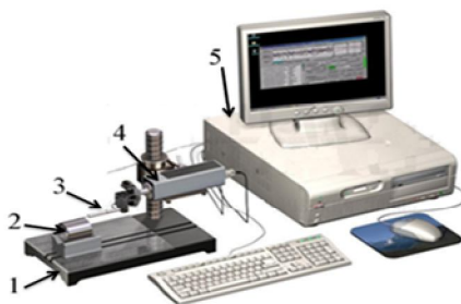
Рис. 8.4. Профилометр: 1 – приборная стойка; 2 – контролируемая деталь; 3 – консоль с иглой; 4 – индуктивный преобразователь; 5 – персональный компьютер
