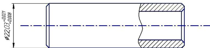
Рис. 4.1. Палец поршневой с указанием предельных размеров
